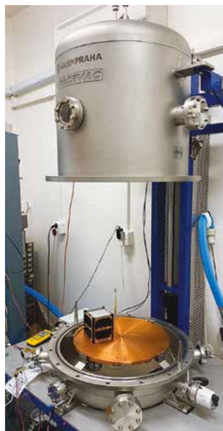
Termovákuvové testy družice v oddelení kozmickej fyziky Ústavu experimentálnej fyziky SAV v Košiciach
