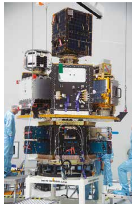
Pripájanie malých satelitov k nákladnému priestoru SSMS – Small Spacecraft Mission Service, európsky vesmírny kozmodróm Francúzska Guayana, 12. marca 2020
