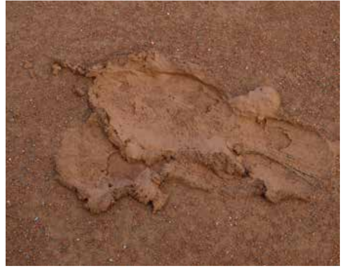
Aj napriek pomerne teplým zimám počas nich voda v antuke niekoľkokrát zamrzne a opäť rozmrzne. Pôvodne pevný kompaktný povrch sa tak premení na obyčajné blato.
