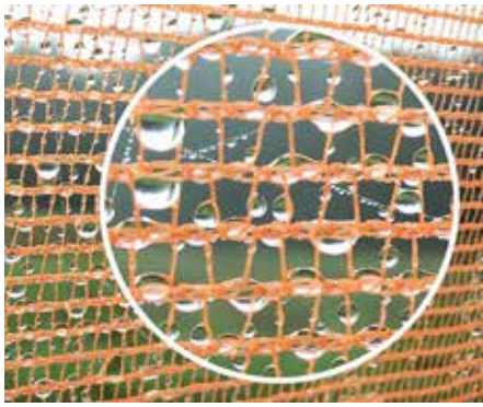
Kvapky skondensovanej vody v pletive veže Warka, foto Arturo Vittori/Warka Water
