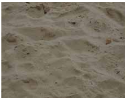
Z kremenného piesku vytvoriť rovný kompaktný povrch nemožno. Súvisí to s tým, že na rozdiel od častíc antuky sú častice piesku nepórovité, majú hladký povrch a sú aj v priemere väčšie.
