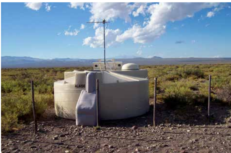
Jeden z 1 660 pozemných detektorov observatória Pierra Augera, foto wikipédia/Roberto Fiadone
