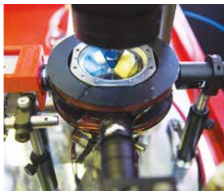
Časť komerčne dostupného gravimetra fungujúceho na základe interferencie atómov. Veľmi presná informácia o lokálnej intenzite gravitačného poľa je dôležitá v mnohých precíznych aplikáciách, foto ESA – G. Porter, CC BY-SA 3.0 IGO.
