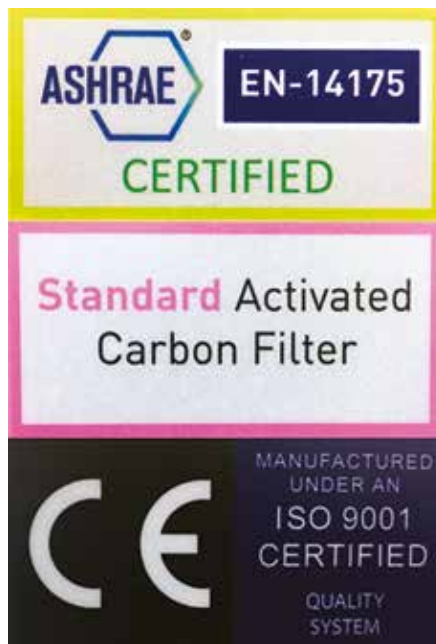
Označenia, ktoré môžete nájsť na moderných certifikovaných digestoroch vybavených vzduchovými filtermi
