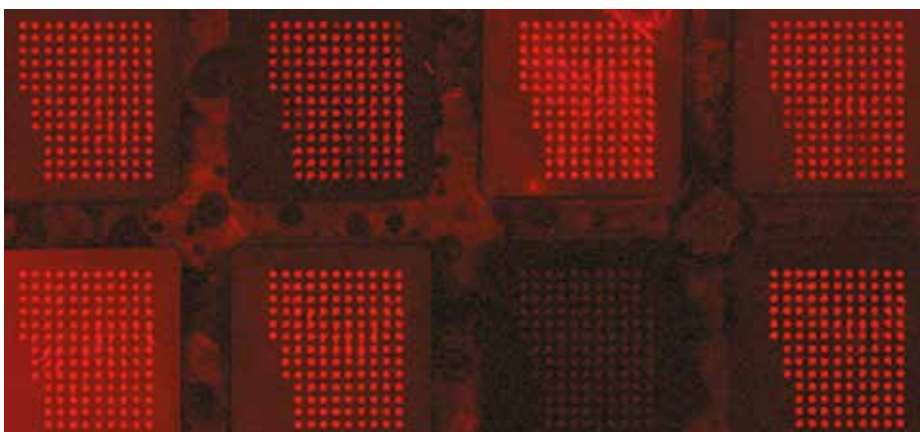
Microarray biočip po inkubácii, na ktorom možno vidieť fluorescenčné signály jednotlivých vzoriek (spotov)
