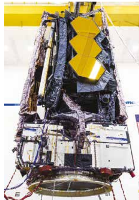
Zostavený a zbalený teleskop, foto wikipédia/NASA Goddard Space Flight Center/Chris Gunn, CC BY 2.0
