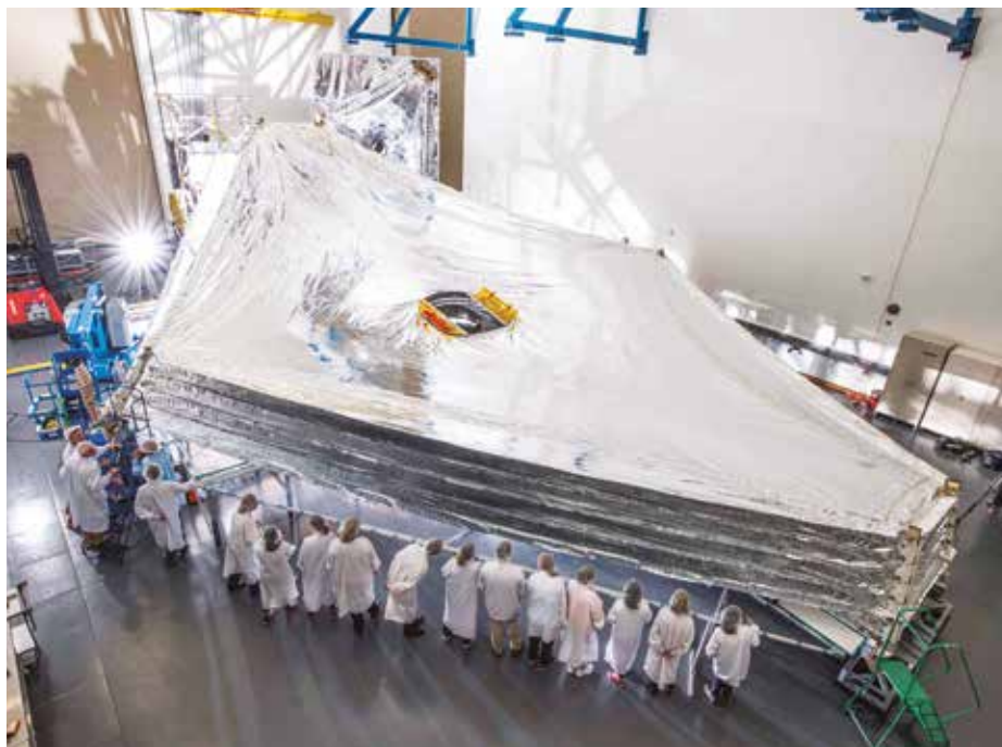
Päť vrstiev slnečnej clony teleskopu, foto NASA/Chris Gunn
